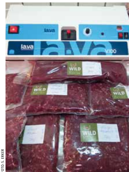
Durch Vakuumieren wird der Sauerstoffgehalt in der Verpackung stark reduziert, das verzögert den Prozess des Ranzigwerdens. Handliche Vakuumiergeräte sind leistbar und sollten in keinem Jägerhaushalt mehr fehlen.
